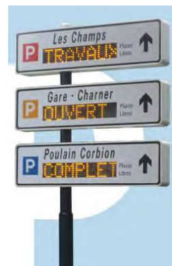
Figure 17 : Exemple d'un système de téléjalonnement
